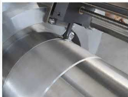
токарная обработка внешних диаметров
